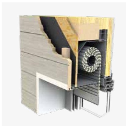
Pose sur maison ossature bois
