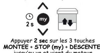
Appuyer 2 sec sur les 3 touches MONTÉE + STOP (my) + DESCENTE, jusqu'au va et vient du moteur.
