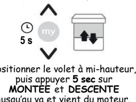
Positionner le volet à mi-hauteur, puis appuyer 5 sec sur MONTÉE et DESCENTE jusqu'au va et vient du moteur.
