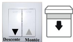
Si le sens de rotation du moteur ne correspond pas avec les flèches de l'interrupteur, inverser les fils noir et marron du moteur sur l'interrupteur.
