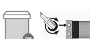
3] Appuyer sur MONTEE jusqu'à l'arrêt du moteur, maintenir l'ordre de montée tout en augmentant la course du moteur (tourner la vis FDC Haut dans le sens+) jusqu'à positionner le tablier en fin de course haute souhaitée (pour corriger, tourner dans le sens -).
